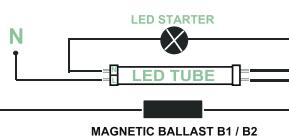
**ΠΡΟΣΟΧΗ!** Ο λαμπτήρας T8 LED HE δεν είναι συμβατός με ηλεκτρονικό μπάλαστ / **ATTENTION!** T8 LED HE tube is not compatible with electronic ballast.
