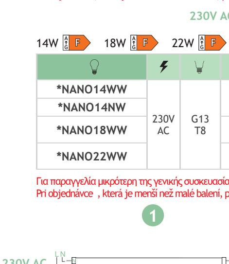
ΠΡΟΣΟΧΗ! Ο λαμπτήρας T8 LED NANO δεν είναι συμβατός με ηλεκτρονικό μπάλαστ! / ATTENTION! T8 LED NANO tube is not compatible with electronic ballast.
